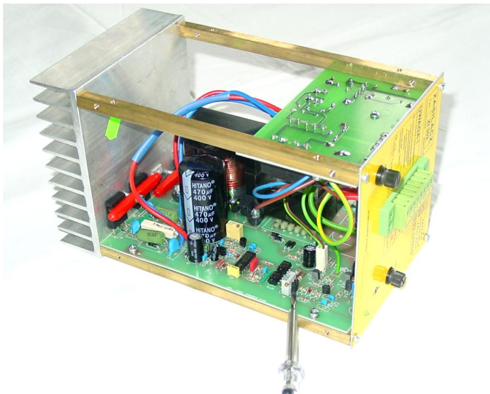
Rys.1. Miejsce zmiany ustawień zworki w zasilaczu ZI-302
